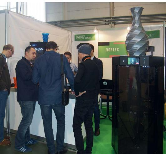
GIANT — диаметр 55 см и высоту печати до 95 см. Как инновационные составляющие для дельта-принтеров были обозначены: достаточно легкая головка, система переключения головок по высоте и полностью автоматизированная система калибровки.
