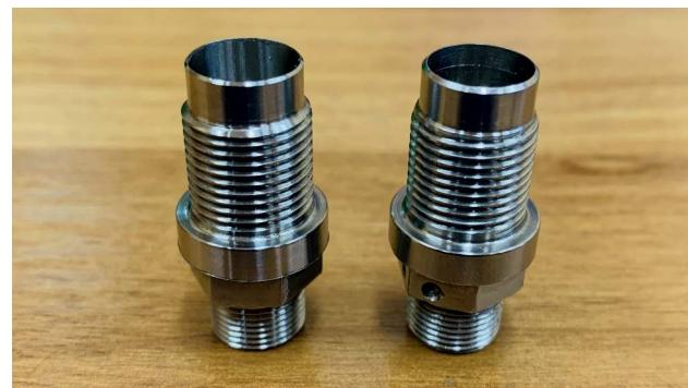
В сварном шве электронно-лучевой сварки имеется вогнутость корня шва. Шов, полученный аргонно-дуговой сваркой, соответствует требованиям нормативов. В обоих случаях в микроструктуре имеются поры и рыхлоты размером до 0,04 мм, микротрешины протяженностью до 0,07 мм, а также структурная неоднородность.
