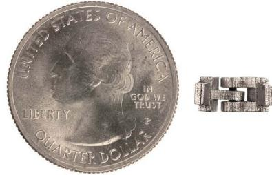
*Рис. 4. Напечатанные образцы с идентификатором и серийным номером*
