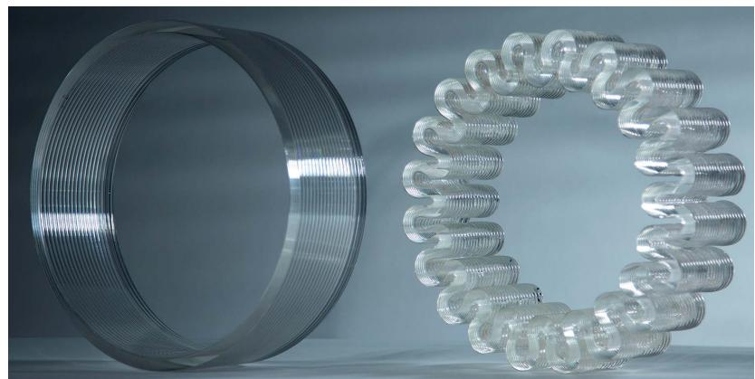
Производительность машины 5 кг/час, что более чем в 2 раза выше, рабочий объем увеличен почти вдвое ( $1100 \times 1100 \times 500$  мм), объем резервуара с жидким стеклом более чем в 10 раз в сравнении с G3DP. Потребляемая мощность в среднем составляет 15 кВт. Примеры образцов показаны на рис. 21 ( $R$ ,  $r$  — радиусы окружно-
