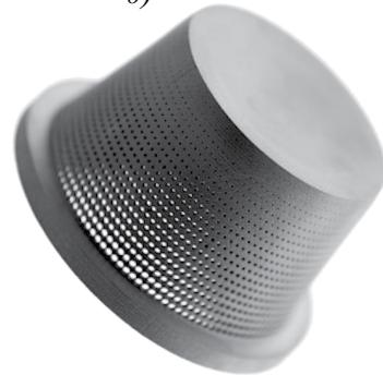
особенно при изготовлении сложных изделий с каналами для охлаждения и подачи топлива или жидкости. При инжекционном литье обычно сложная деталь изготавливается из двух частей с последующей сваркой их друг с другом. Если же изготавливать такое изделие как единое целое при использовании BJ, то мы экономим материал, время и снижаем вес изделия (рис. 10–11).
