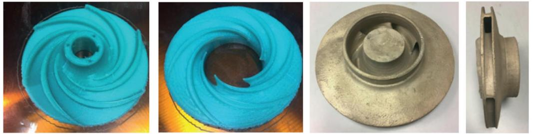
Рис. 8. Сравнение поверхности модели до и после механической постобработки на фрезерном станке с ЧПУ
