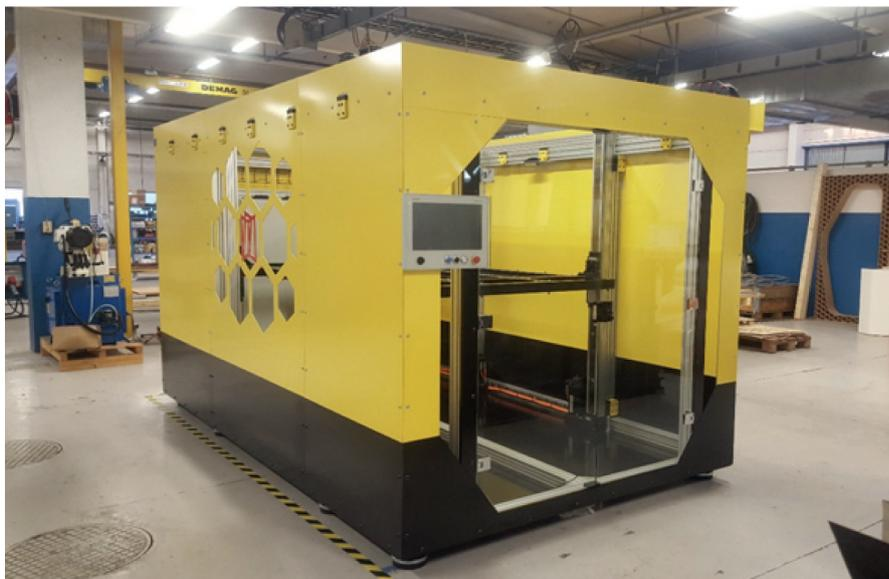
Затем с помощью программного обеспечения TOP 3DP нарезают модель пресс-формы STL и получают геометрическую информацию для формирования слоев поперечного сечения. Эти слои сечения используются для формирования информации управления процессом. Терминальное устройство считывает эту информацию управления процессом и создает форму с помощью 3D-печати.
