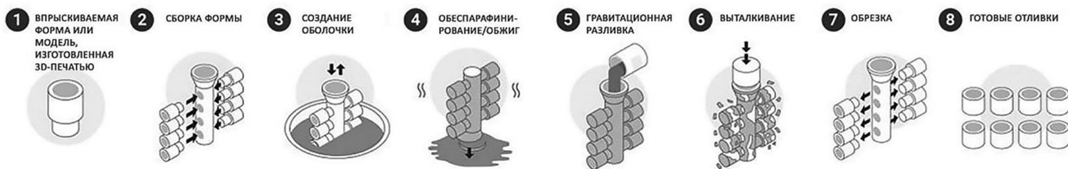
Рис 17б. Процесс аддитивного построения формы без модели для высокоточного литья.
