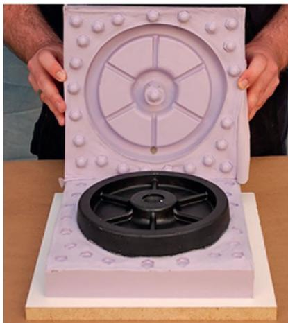
Готовая мастер-модель помещается в формовочный короб и заливается силиконом (для лучшего качества применяется его платиновая разновидность), а затем аккуратно вынимается из формы. Затем в полученную матрицу заливается специально подготовленная двухкомпонентная смесь (пластик и катализатор). Все это отправляется в специальный термошкаф, где происходит окончательное затвердевание изделия при температуре 70°C.
