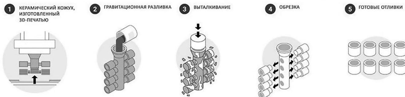
DLP (цифровой светодиодный проектор) — керамические формы для высокоточного литья — еще одна аддитивная технология построения форм без модельной оснастки
