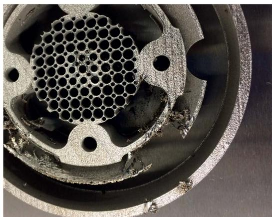
Рис. 7. Отрыв системы поддержек напечатанной детали
