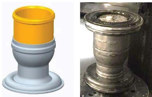
— селективное лазерное сплавление (SLM) порошка меди GRCo-84 для изготовления лайнера с контуром охлаждения камеры сгорания;
