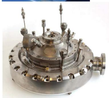
Уменьшения числа деталей удалось добиться благодаря использованию одного из главных преимуществ АТ – возможности построения монолитных конструкций со сложной внутренней структурой, а таких в ЖРД очень много.
