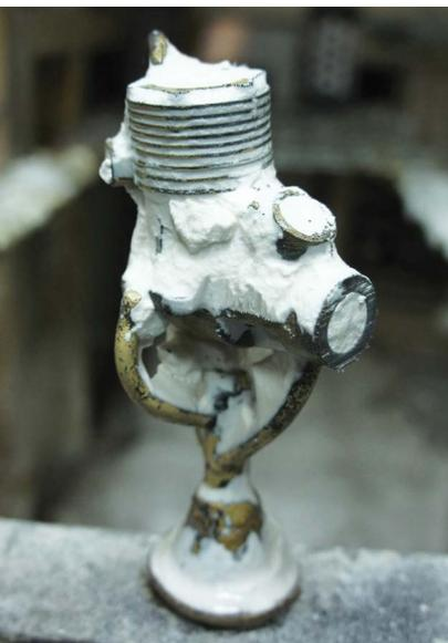
На следующем этапе отлитая деталь подвергнется механической обработке. Отделяются литники и проводится абразивная обработка (рис. 10).
