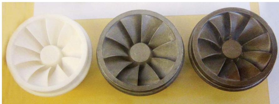
Рис. 6. Прототип форсунки с завихрителем изготовлен по технологии DMLS фирмы EOS GmbH, Германия. Представлен «АБ-Универсал»
