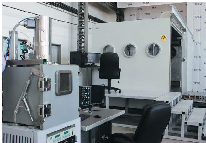
ЭЛАТ — высокопроизводительная технология 3D-печати, позволяющая формировать изделия даже из трудносплавляемых сплавов (титана, тантала, вольфрама) со скоростью до 9 кг/ч. Полученное по данной технологии изделие обладает свойствами литого материала. Кроме того, процесс формирования детали происходит в вакууме, что позволяет работать со сплавами, которые «боятся» атмосферы.
