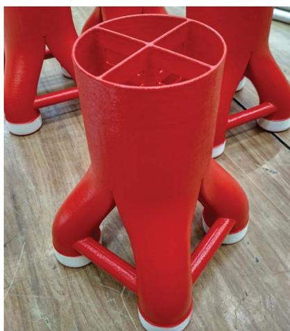
Так как выращивание происходит по разработанной конструктором электронной трехмерной модели, из технологического цикла исключается необходимость выпуска конструкторской документации и изготовления инструментальной оснастки, что значительно ускоряет и удешевляет подготовку производства. Кроме того, еще одно важное преимущество 3D-печати — возможность оперативного внесения
