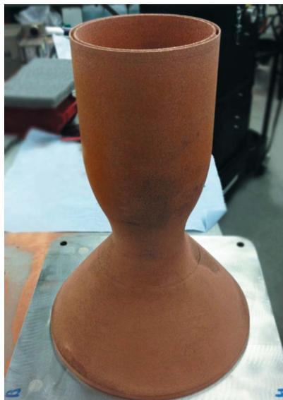
гателя (рис. 1) [2]. Камера сгорания — один из ключевых элементов жидкостного ракетного двигателя, работающий при экстремально высоких температурах. Для предотвращения теплового разрушения камеру изготавливают из жаропрочной бронзы с внутренней системой каналов для циркуляции охлаждающей среды.
