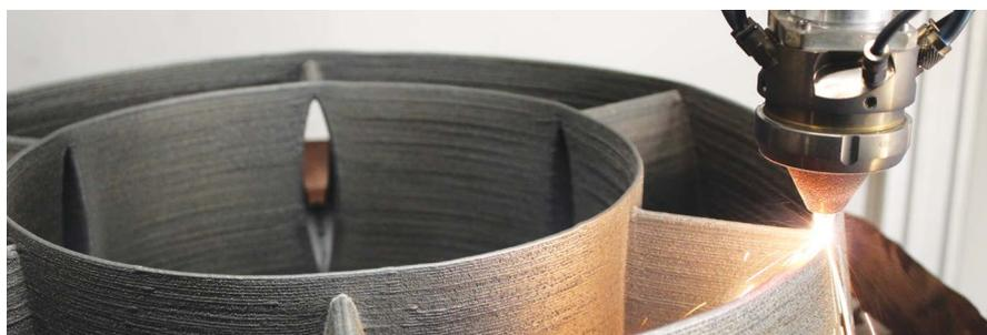
Рис. 2. Изделия, полученные методом прямого лазерного выращивания на оборудовании, разработанном в ИЛИСТ
