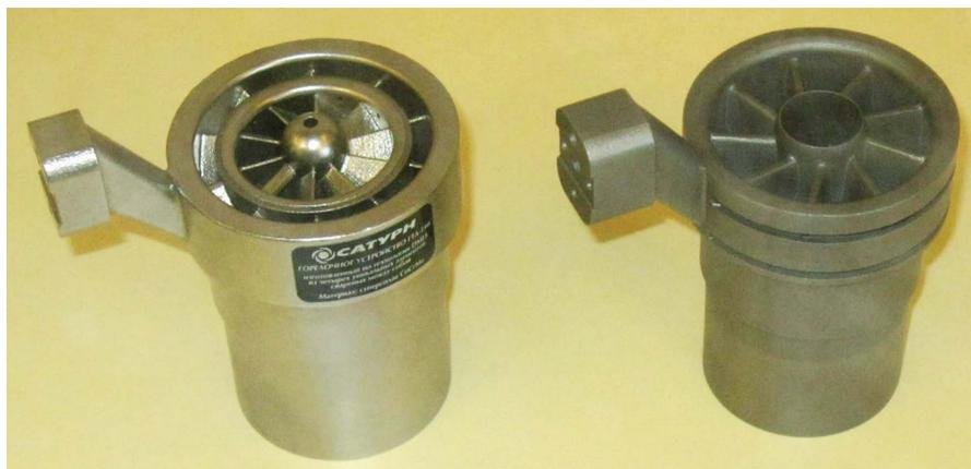
Рис. 5. Напечатанная выжигаемая модель «Крыльчатка» и отливки. Оборудование: 3D-принтер Voxeljet VB500, Германия; материал модели — полиметилметакрилат, вид литья — ЛВМ, материалы отливки: алюминий АК7ч и сталь 40. Срок изготовления 8–25 дней. Представлены компанией ГК «Остек»
