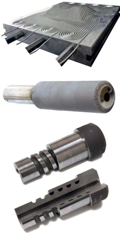
ка, при ударе которых о подложку или предыдущие слои возникают значительные пластические деформации растяжения, превышающие 10 ГПа при температуре около 1000°С и формируется диффузионная связь между частицами и нанесенным ранее материалом.
