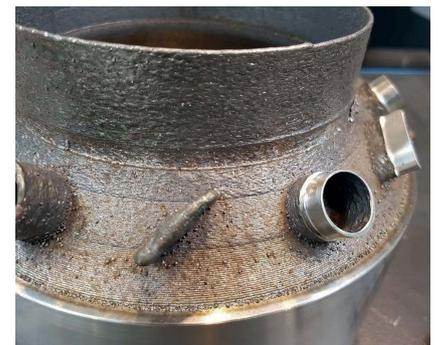
Рис. 10. Рабочая зона и изделие, изготовленное на токарно-фрезерном обрабатывающем центре WFL M80 MillTurn, оснащем лазерной наплавляющей головкой Precites YC52
