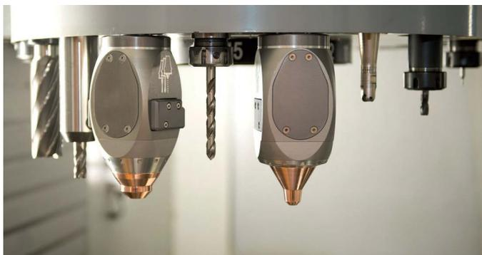
В частности, компания Hybrid Manufacturing Technologies выпускает специализированные головки для лазерного наплавления порошковых металлических материалов (Directed Energy Deposition – DED) серии AMBIT (рис. 2), устанавливаемые в инструментальный шпиндель станка или в схват промышленного робота. Головки отличаются размером и формой пятна лазера и фокусного расстояния, а также интенсивностью подачи порошков. Аддитивное построение реализуется в соответствии с управляющей программой от СЧПУ станка.
