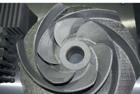
была разработана технология по доведению плоских и криволинейных поверхностей детали типа «Колесо» с помощью финишной обработки до требований по шероховатости и проведен химический анализ металлического порошка 12X18 Н10 Т для подтверждения его химического состава.
