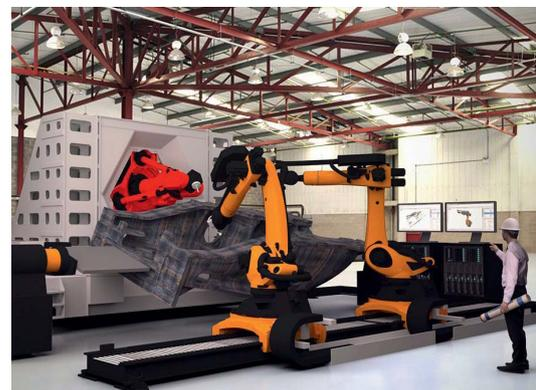
Компоновка производственной ячейки строится по модульному принципу, обеспечивающему изменение ее конфигурации и масштабирование в соответствии с поставленными задачами. Планируется изготовление изделий из сталей, алюминиевых и титановых сплавов.
