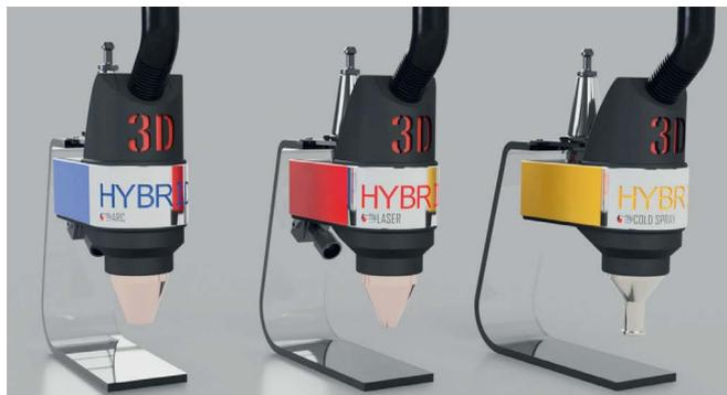
DED-головки оснащаются лазером мощностью от 0,5 до 25 кВт и имеют возможность нанесения материала под углом 90° к поверхности. Размер пятна лазера варьируется в пределах  $0,1 \pm 10$  мм и имеет круглую или прямоугольную форму. Подача металлического порошка в зону построения реализуется питателями (максимально — 4 шт.) емкостью от 1 до 4 л. При помощи пирометров осуществляется мониторинг температуры ванны расплава.
