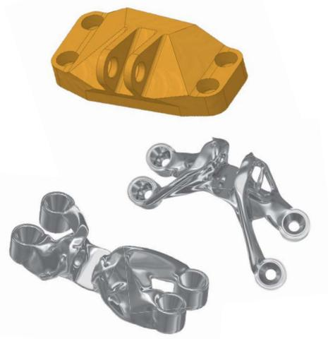
360. Основное отличие заключается в том, что система сама выращивает форму детали в зависимости от поставленных задач и введенных параметров. Необязательно использовать какой-то прототип для его дальнейшей доработки, как это происходит при топологической оптимизации, например, в Inventor.
