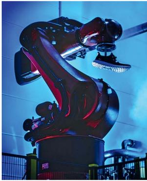
Рис. 1. Adidas использует роботы для сборки кроссовок
