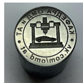
г) формообразующая поверхность верхнего инструмента
