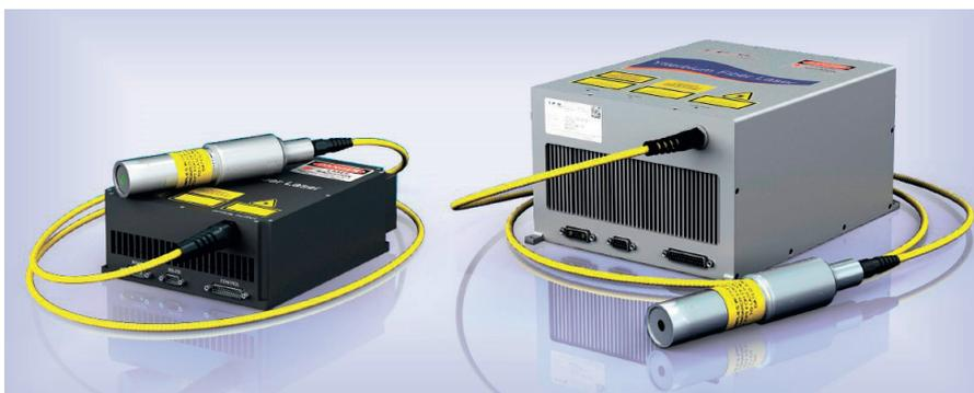
Отличительные особенности данной серии: промышленное исполнение, компактность, высокая надежность, воздушное охлаждение, средняя выходная мощность — до 100 Вт, качество излучения  $M2 < 2$ . Лазеры серии YLP-V2 генерируют импульсное излучение с длиной волны 1,064 мкм со средней выходной мощностью до 100 Вт, энергией в импульсе — 1 мДж. Длина импульса — 100 нс.
