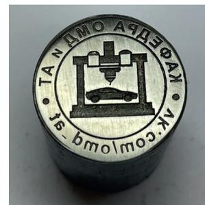
г) формообразующая поверхность верхнего инструмента
